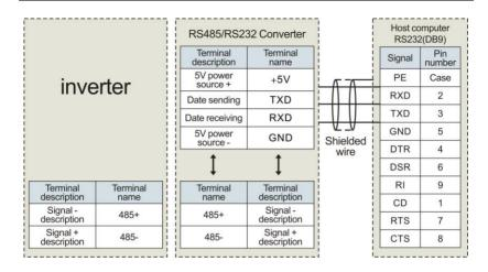
Fig. 3-13 RS485-(RS485/232)-RS232 communication wiring
