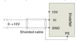
Fig. 3-9 VI terminal wiring
